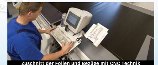
Zuschnitt der Folien und Bezüge mit CNC Technik
