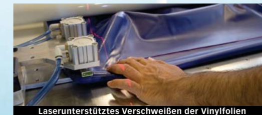
Laserunterstütztes Verschweißen der Vinylfolien
